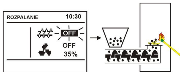
Rys. 6 Wyłączenie podajnika w rozpalaniu
