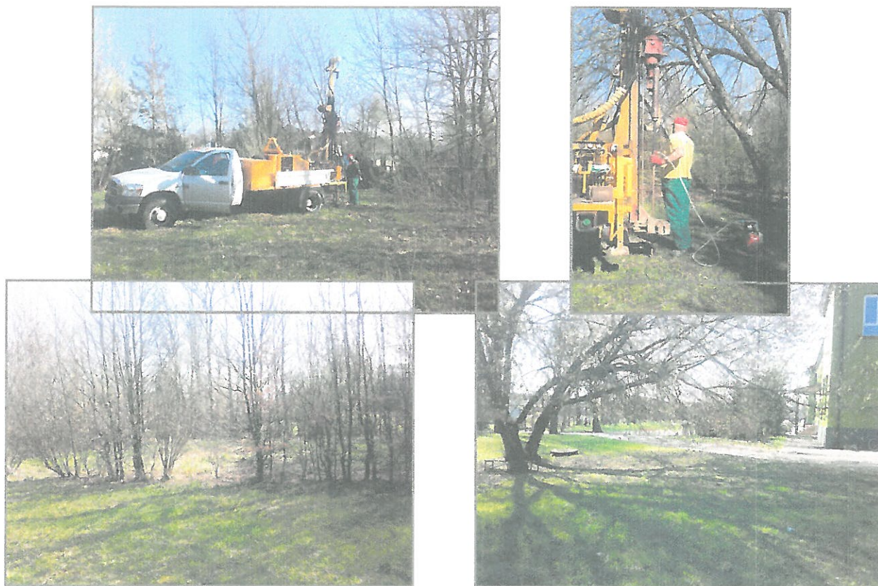
Ryc.1. Teren badań i sondowania dynamiczne DPL
