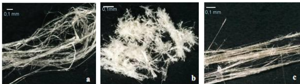
Rysunek 3. Długowłknisty azbest chryzotylowy praktycznie nie zawierający zanieczyszczeń (a), chryzotylowy azbest krótkowłknisty zanieczyszczony talkiem (b) i azbest amozytowy (c) [źródło: Bezpieczne postępowanie z azbestem i materiałami zawierającymi azbest].
