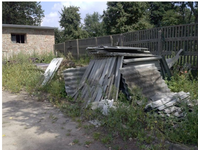
Rys. 2. Odpady zawierające azbest – zmagazynowane płyty faliste.
