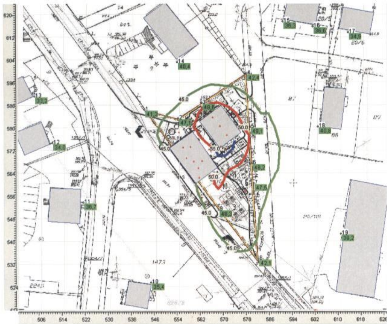
Rys. 1. PORA DNIA. L_{AeqD} = 55 dB. Mapa zasięgu hałasu. Poziomy dźwięku A w sieci receptorów i w punktach obserwacji.
