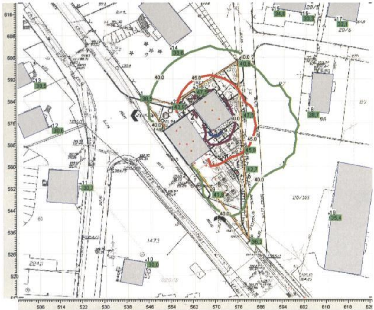
Rys. 2. PORA NOCY. L_{AeqN} = 45 dB. Mapa zasięgu hałasu. Poziomy dźwięku A w sieci receptorów i w punktach obserwacji.
