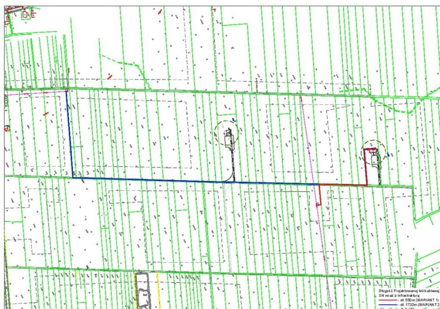
Rycina 14. Schemat przyłączenia elektrowni wiatrowych
