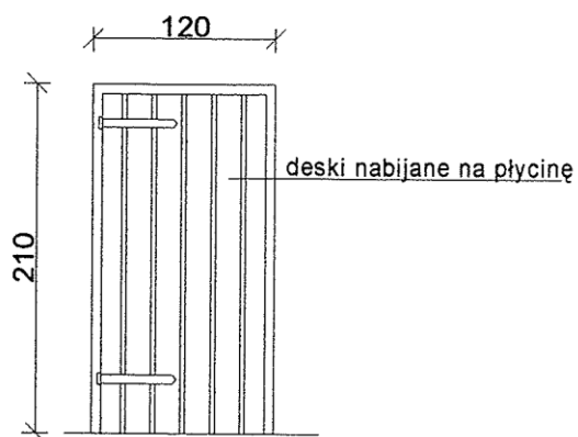
drzwi zewnętrzne Dz1 - 1szt. widok skala 1:50
