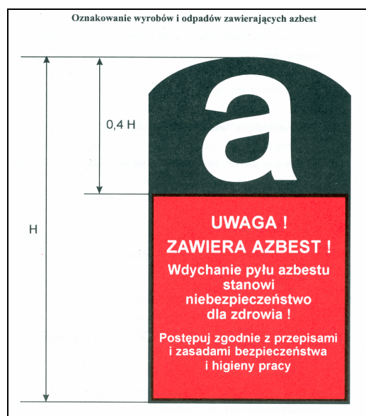
Rysunek 6.2. Stosowane oznakowanie wyrobów i odpadów zawierających azbest (Dz. U. Nr 138, poz. 895 z 1998 r).
