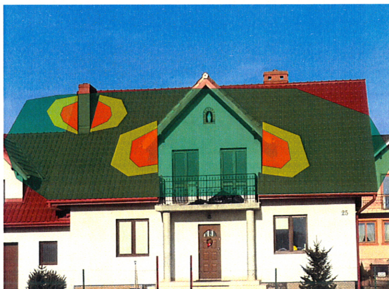
Rys. 16 Strefy zacinienia na dachu skierowanym na południe
