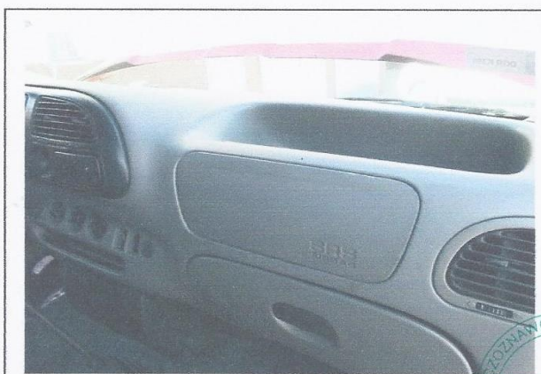
Brak poduszki powietrznej
