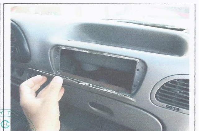
Brak poduszki powietrznej
