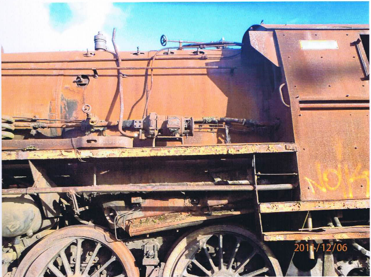
Stojak kotła oraz fragment budki maszynisty
