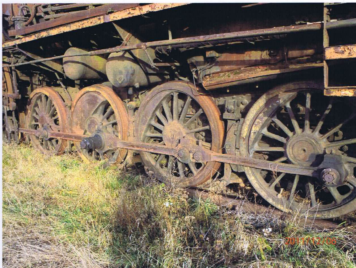
Układ napędowy z lewej strony; brak korbowodów, przeciwkorby, drążka mimośrodowego
