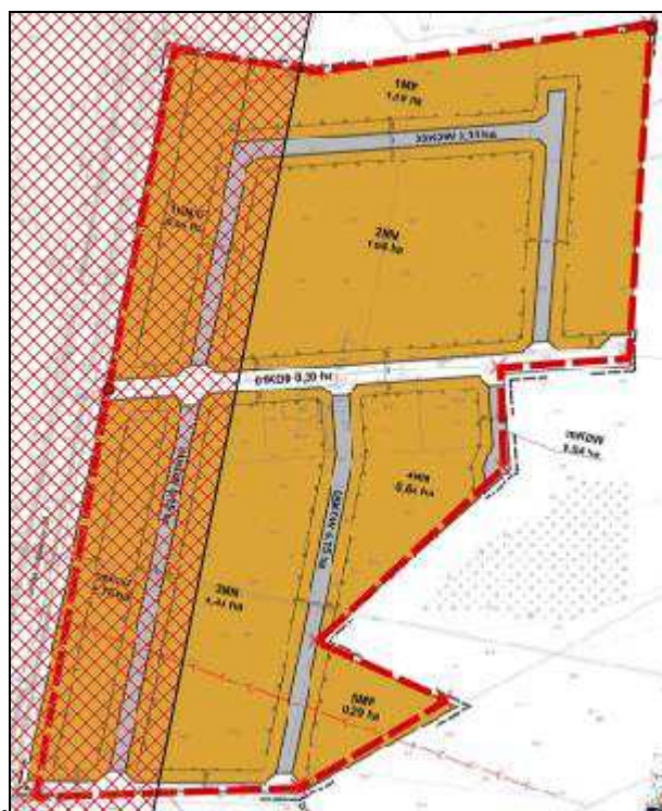
Rys. 1 Potencjalne oddziaływanie emisji z drogi krajowej w przypadku natężenia ruchu ponad 7000
