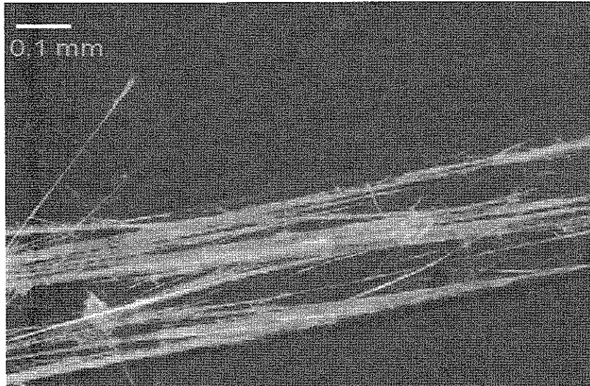
Fot. 2. Azbest amozytowy (grupa azbestów amfibolowych).
