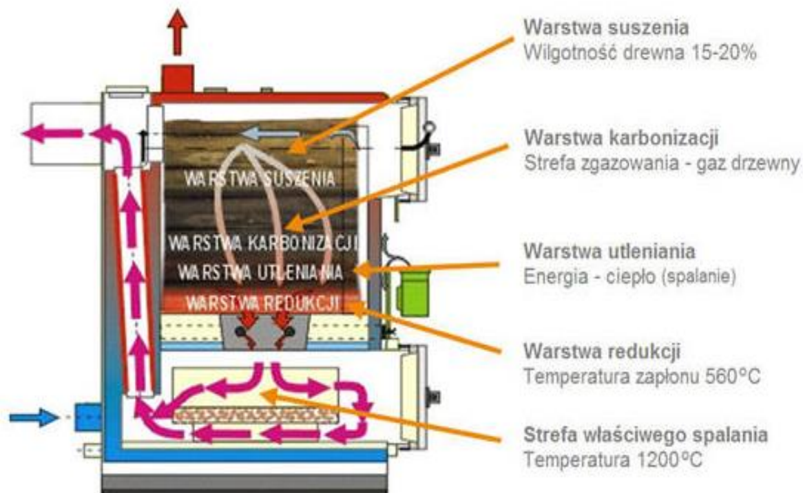
Ryc. 22. Schemat spalania drewna w kotle zgazowującym
