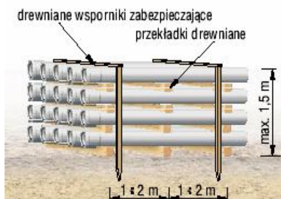
Rysunek poglądowy składowania rur PVC na placu budowy
